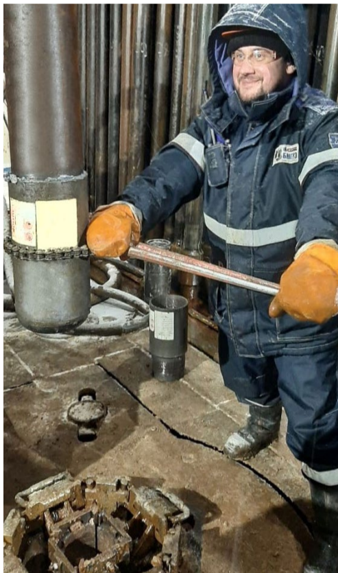
Помощник буровика эксплуатационного и разведочного бурения скважин на нефть и газ 5-го разряда Максим Прудников выполняет работы по спуску обсадной колонны в скважину на КП-123
